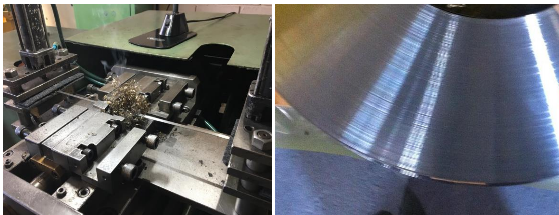
Foto do cabeçote do equipamento de tratamento de cantos e produto canto tratado.
