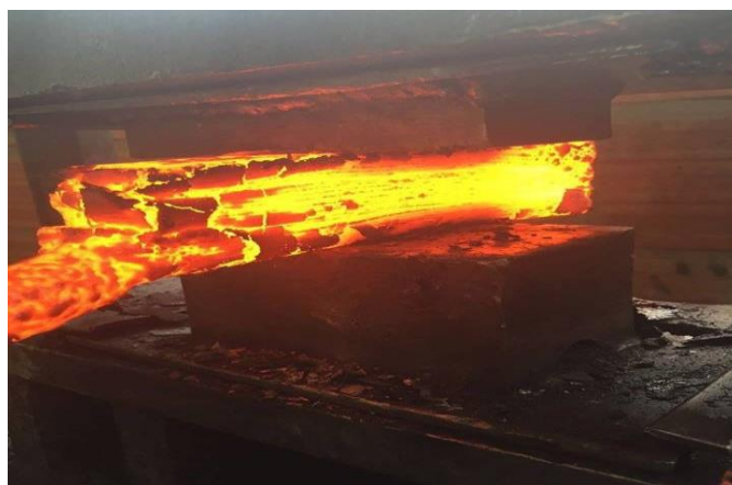
Fig. 5 - Tarugo de aço DAMASCO sendo forjado.
