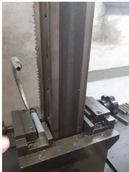
Figura 26 - Brochadeira para entalhe em "V"
