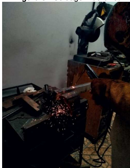
Figura 8 - Soldagem do billet
