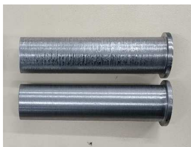
Figura 24 - Corpos de prova - Jominy
