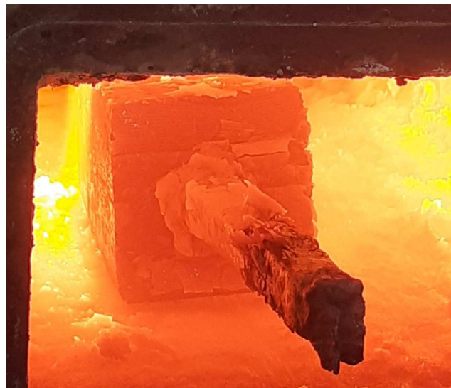
Figura 11 - Billet de damasco com 168 camadas
