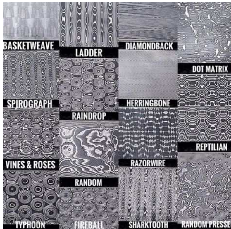
Figura 1 - Padrões de aço damasco
